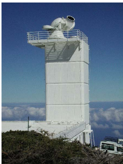
図 I-2-1. Swedish Solar Telescope。1m の口径を持ち、補償光学を併用することで、現時点で世界最高の空間分解能を実現している望遠鏡である。
