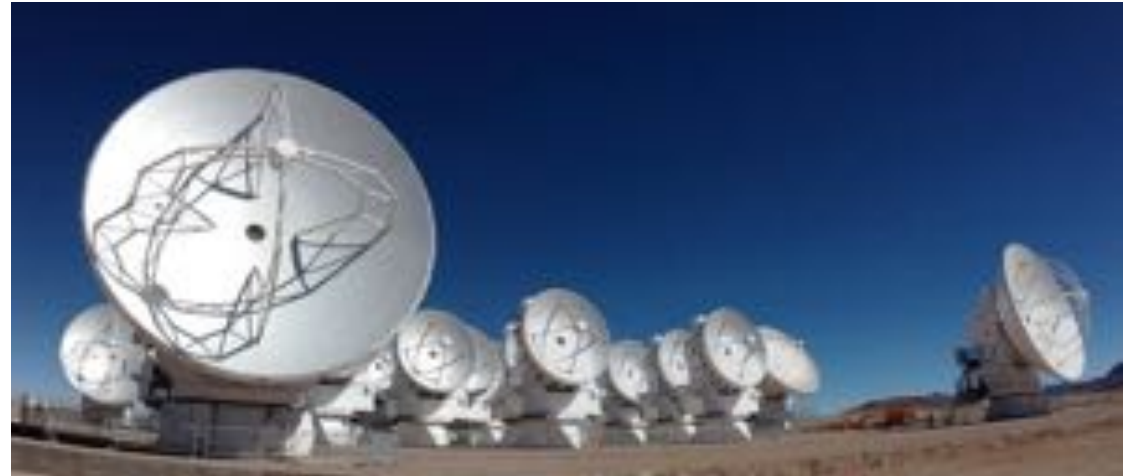
アルマ望遠鏡 (12m/7mのパラボラアンテナ66台) 南アメリカ・チリにある電波望遠鏡
