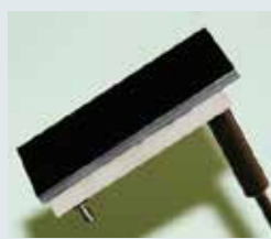
赤外線に感度の高いメガピクセルCCD（2,048×4,096ピクセル/受光面は3cm×6cm角）。
