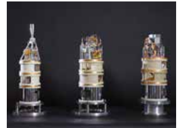
国立天文台が開発したアルマ望遠鏡の受信機。左から、バンド4（ミリ波、受信周波数 125～163 GHz）・バンド8（サブミリ波、385～500 GHz）・バンド10（テラヘルツ波、787～950 GHz）。★01
