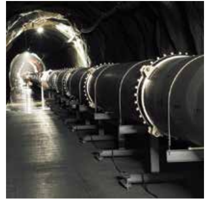
大型低温重力波望遠鏡KAGRAの干渉計を構成する真空ダクト（右）。KAGRAの心臓部にあたる大型鏡懸架装置は国立天文台で開発されました。赤い色の保護剤で覆われているのが鏡です（中央）。
